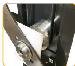
Cinghie autotensionanti - Self tensioning belts Courroies auto tendues - Selbstspannende Riemen
