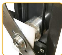
Cinghie autotensionanti - Self tensioning belts
